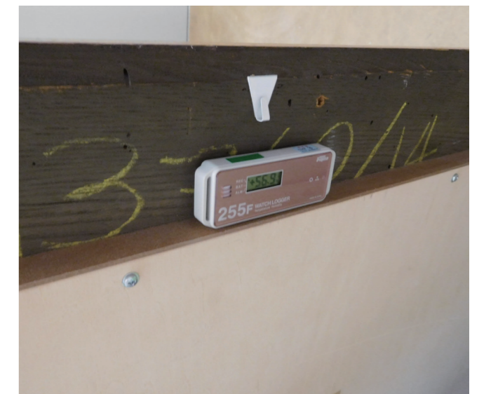
図2 作品額裏にデータロガーを装着した様子。ロガーの大きさはH34 mm × W90 mm × D15 mm。
