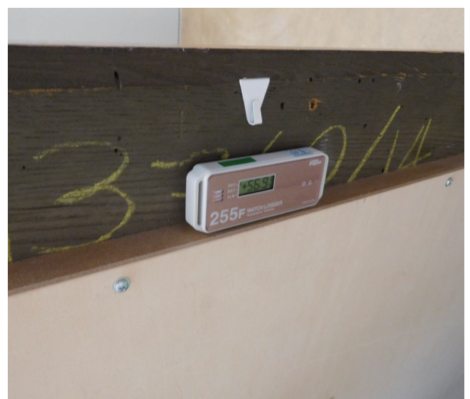
図2 作品額裏にデータロガーを装着した様子。ロガーの大きさはH34 mm × W90 mm × D15 mm。
