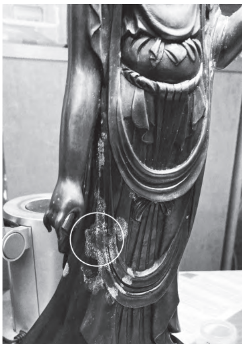
写真 64 上記溶液を 221 ゲルシートに浸したものを、ブロンズ病がみられる箇所に 24 時間おいた状態
