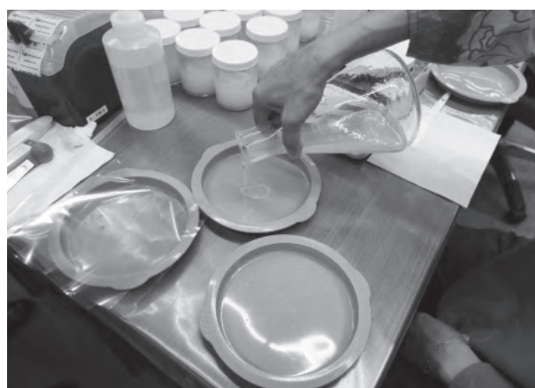
写真8 221ゲルをシリコン製容器に流し入れている様子
