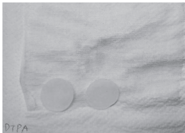
写真 50 試料④ テスト後 (DTPA 溶液+メタ重亜硫酸ナトリウム/キサンタンガム)
