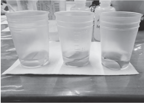
写真13 溶液（イオン交換水、調整水 10,000 \mu\text{S}/\text{cm} 、19,000 \mu\text{S}/\text{cm} ）へ浸漬中
