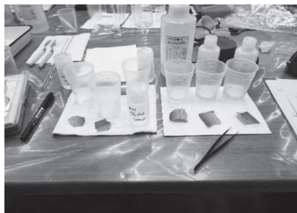
写真 27 異なる導電率のクリーニング比較
