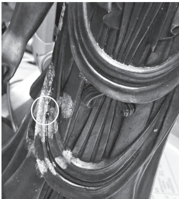
写真 67, 68 ゲル使用前(左)、ゲル処置および洗浄後(右)の比較。ゲル処置および洗浄後は、色が若干薄くなり、粒子状に発生した緑青が少なくなっていることがわかる。
