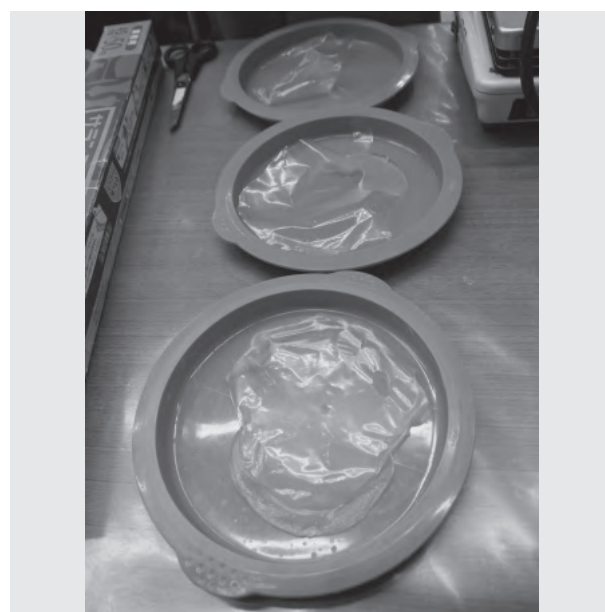
写真10 乾燥後の221ゲルシート（手前のシリコン容器のゲルはまだ完全に乾燥していないが、それ以外は水分が完全に蒸発して薄く張りのあるシートが出来上がった。）
