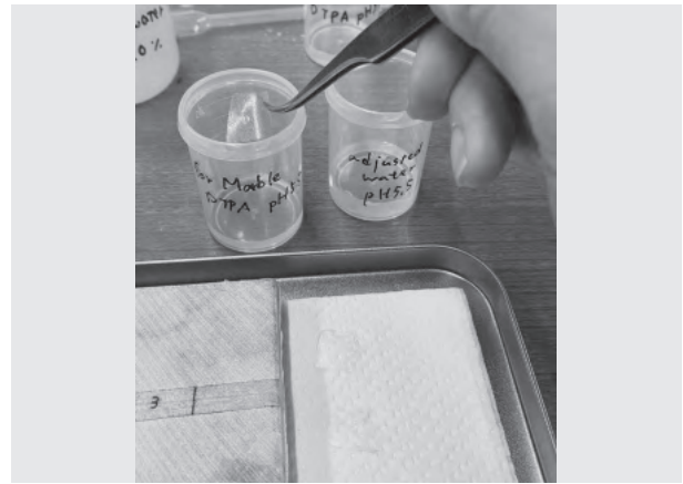
写真 83 221 ゲルシートを溶液に浸す様子
