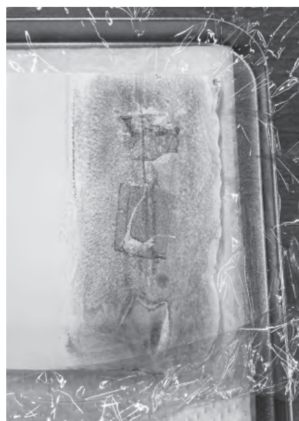
写真79 溶液に浸した221ゲルシートを置く
