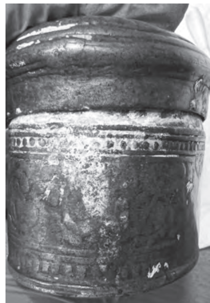
写真 72,73 右は①テスト後、左は③テスト後 (③テスト後は、中央部分の緑青が薄くなった。)
