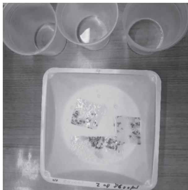
写真 56 テスト後（DTPA 溶液+メタ重亜硫酸ナトリウム/キサントランガム）
