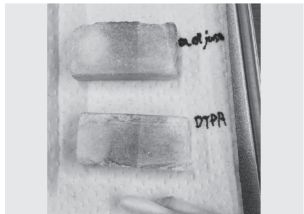
写真 89 写真 88 のクリーニング及びすすぎ洗浄後（上下いずれも左：綿棒でのみクリーニング、右：溶液+221 ゲルシート使用）
