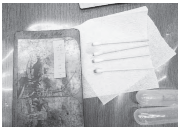
写真 24 様々なすすぎ洗浄液を使用したクリーニングテスト
