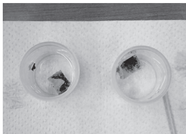
写真 21 8.5pH 調整水 (左) の方が液が若干黄色くなった。
