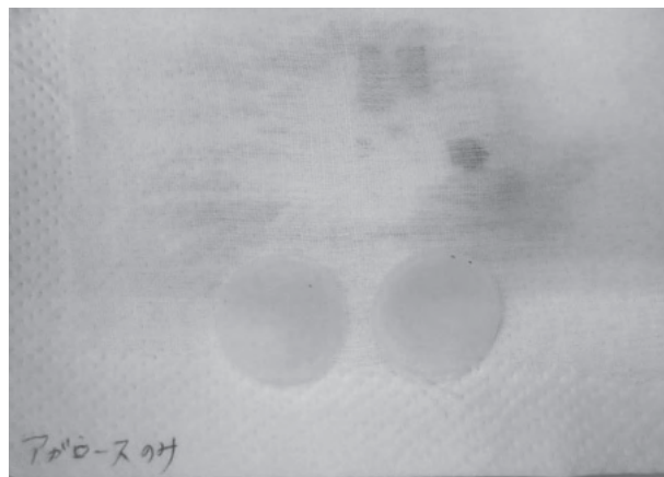
写真 54 試料⑤ 未処置の鉄錆木綿布 処置 3 日後 (写真のゲル左は試料の裏側、右は試料の表側に当てられていたもの)
