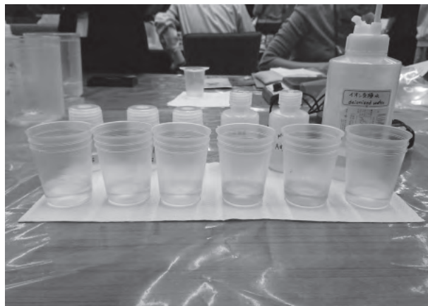
写真17 浸漬後の洗浄効果（左から調整水 2,000 \mu\text{S}/\text{cm} 、4,000 \mu\text{S}/\text{cm} 、7,000 \mu\text{S}/\text{cm} 、10,000 \mu\text{S}/\text{cm} 、19,000 \mu\text{S}/\text{cm} 、イオン交換水）
