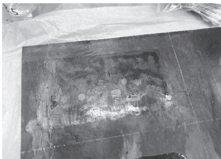
写真 57 ダンマル樹脂が塗布された部分のクリーニング溶液テスト後
