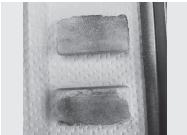
写真 88 石炭煤が付着したテストピース
