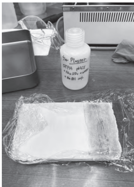
写真76 石膏用 DTPA 溶液とテストピース
