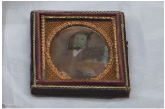
図 31 8分の1プレートのダゲレオタイプ。右下にガラスの劣化が見られ、アルカリ性の液滴として現れている (p35 図 2-27 参照)。プレート自体は貴金属のジュエラーによって作られており、銀製品のように左下に刻印がある場合がある。一般に、フレーム内側の空気が溜まりやすい部分から変色が進行するが、本作では中央の人物の顔部分に劣化が見られる。原因は不明だが、1950年代にはクリーニングにチオ尿素などが使用されることがあった。のちに問題が判明して現在では使用されなくなったが、そうしたクリーニング試験の痕跡がダゲレオタイプに残ることもあり、本作もその可能性が考えられる。
